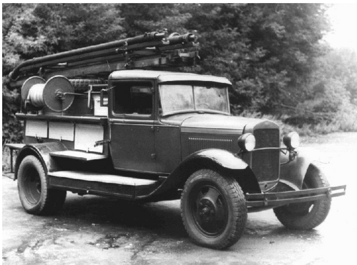
Пожарный автомобиль ПМГ-1 на шасси ГАЗ-АА (1932 г.)
