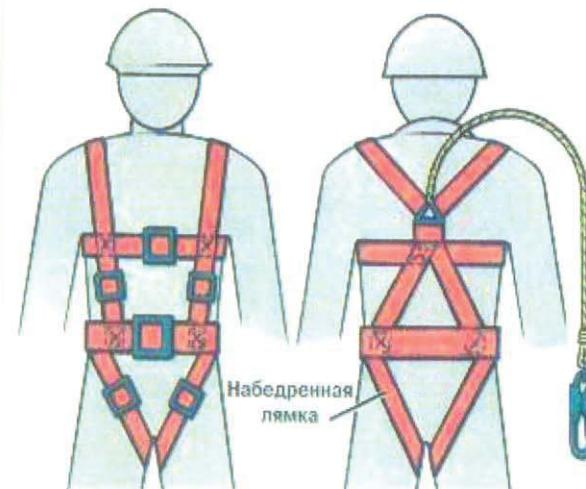
Работы связаны с перемещением в основном по вертикали или по поверхности с наклоном к горизонтали более 45° (тип Да) или 75° (тип Еа)
